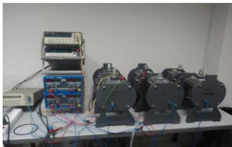
C/ Essai de diffusion des ions chlorure
