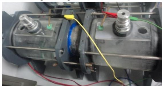
D/ Cellule d'essai de la diffusion
