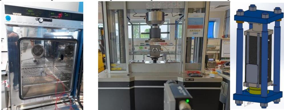
**FIGURE 5.** Campagnes de tests du capteur en laboratoire (sensibilité thermique, et essais sous presses)
